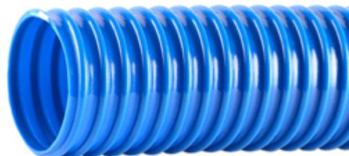
Hochflexibler, sehr leichter und dünnwandiger Schlauch aus PVC mit glatter Schlauchseele. Außen gewellt. Geeignet für den Einsatz als Belüftungsschlauch, Entlüftungsschlauch, Ventilationsschlauch, Klimaschlauch, Rauchgasschlauch, Gasschlauch und Staubabsaugungsschlauch. Ebenfalls als Kabelschuttschlauch und Überzugsschlauch für die Erdverlegung geeignet.
